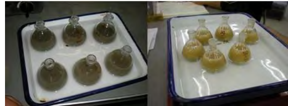
写真5-2 土粒子の密度試験
