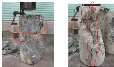
図13. 打継ぎ試験体の圧縮試験後の破壊状況
