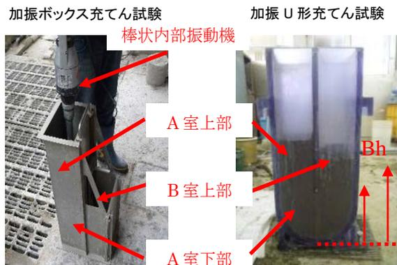
写真-1 間隙通過試験器
