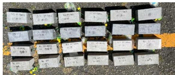
写真-2 海洋曝露試験の供試体例
